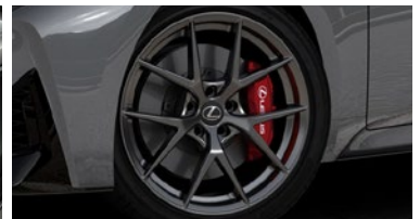
NEUMÁTICOS DELANTEROS 235/40 R19 Y TRASEROS 265/35 R19
